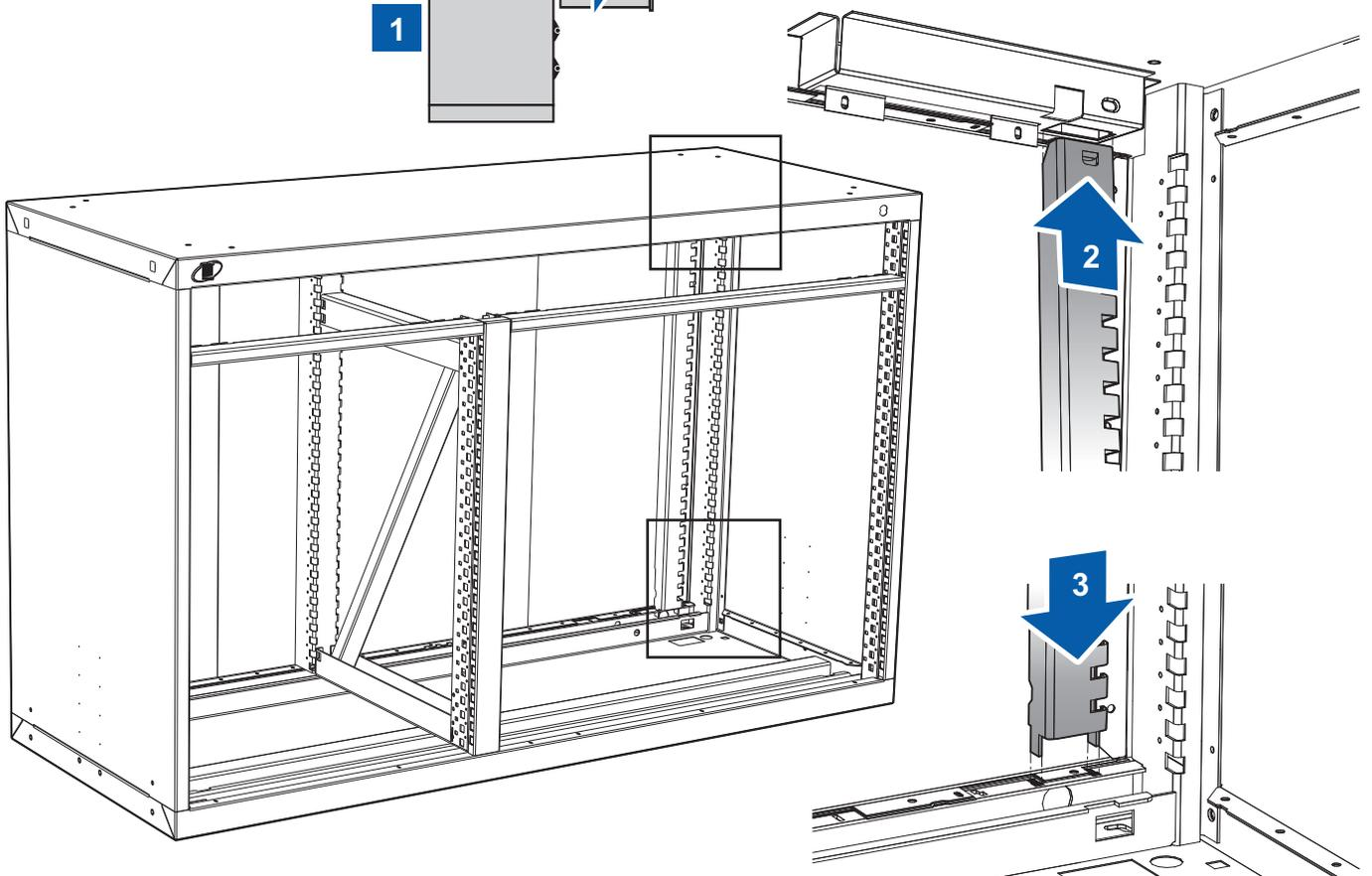
**Insert Mechanism Into The Cabinet** *Insérer mécanisme dans le cabinet*
