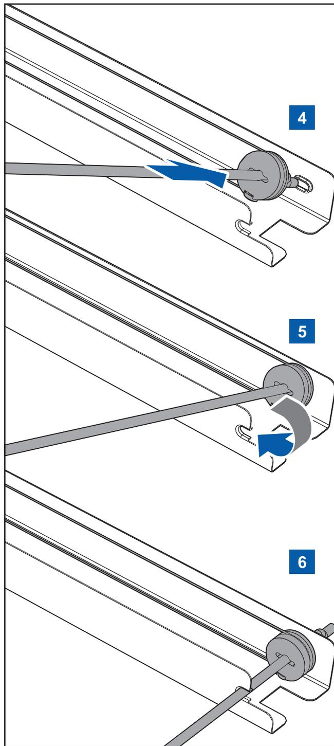
**Locking Bar Assembly** *Assemblage des barres de verrouillage*
